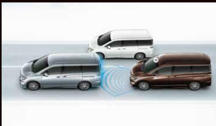
高速道路走行時に、つねに車速を制御し先行車を追従走行できるインテリジェントクルーズコントロール\*を搭載。ドライバーの負担を軽減し、快適な走行を提供します。
